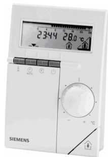
Raumgerät QAW70 mit Raumfühler, Schaltuhr, SollwertEinstellung und Raumtemperaturkorrektur (Drehknopf)
